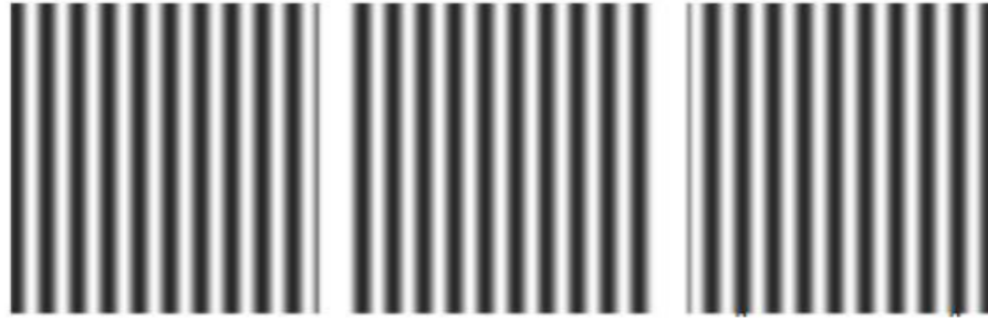
Figura 2.1: De izquierda a derecha, patrones de interferencia para los corrimiento \delta_1 = -2\pi/3 , \delta_2 = 0 , y \delta_3 = 2\pi/3 .
