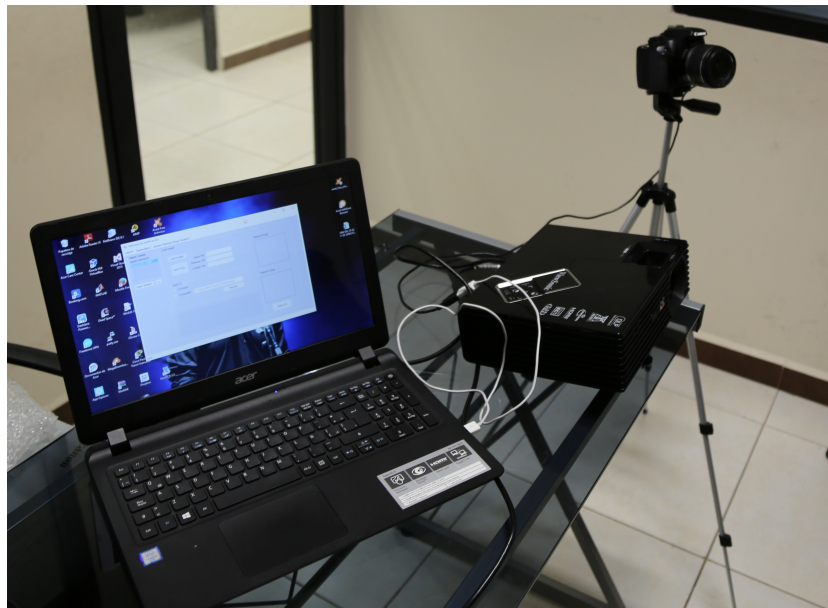
Figura 5.3: Sistema de rectificación conformado por una cámara, un proyector y una computadora.
